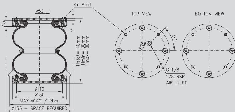
On request, the air inlet thread may be changed to M10x1; possibly, its placement may be changed. / Závit na přívodu vzduchu na požadání může změnit na M10x1, příp. změnit jeho umístění. / Резьбу на входе воздуха, по требованию, можно изменить на M10x1 или же изменить место расположения входа.
