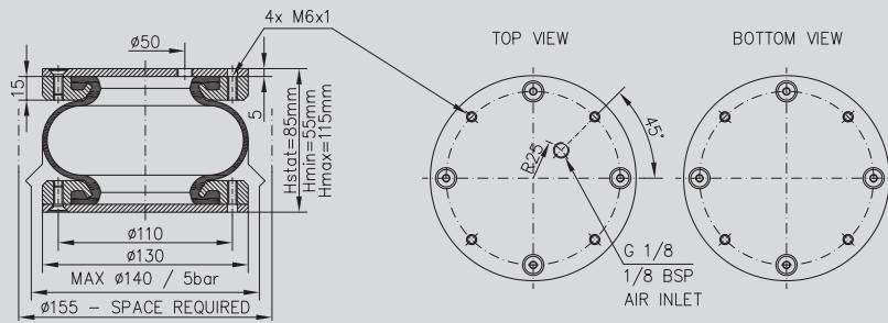
On request, the air inlet thread may be changed to M10x1; possibly, its placement may be changed. / Závit na přívodu vzduchu na požadání může změnit na M10x1, příp. změnit jeho umístění. / Резьбу на входе воздуха, по требованию, можно изменить на M10x1 или же изменить место расположения входа.
