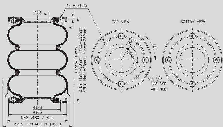
On request, the air inlet thread may be changed to M10x1; possibly, its placement may be changed. / Závit na přívodu vzduchu na požadání možno změnit na M10x1, příp. změnit jeho umístění. / Резьбу на входе воздуха, по требованию, можно изменить на M10x1 или же изменить место расположения входа.
