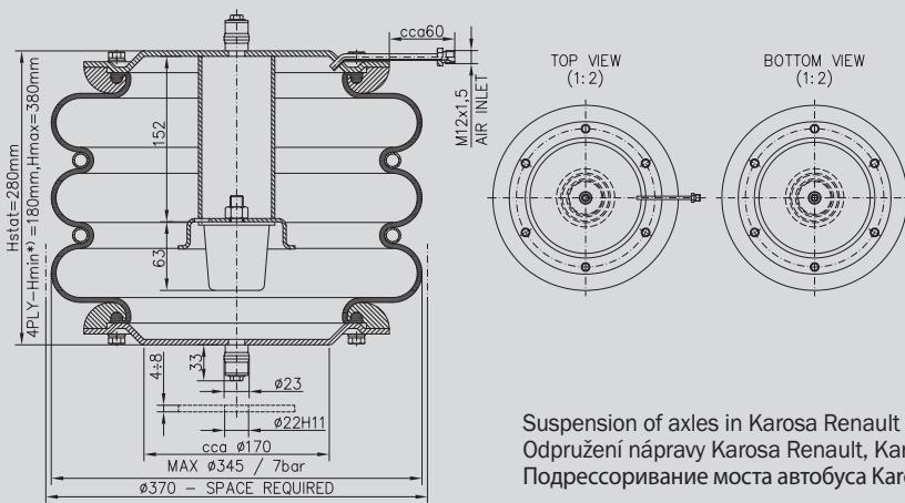
Suspension of axles in Karosa Renault and Karosa Iris buses. / Odpružení nápravy Karosa Renault, Karosa Iris Bus. / Подпрессоривание моста автобуса Karosa Renault, Karosa Iris Bus.
