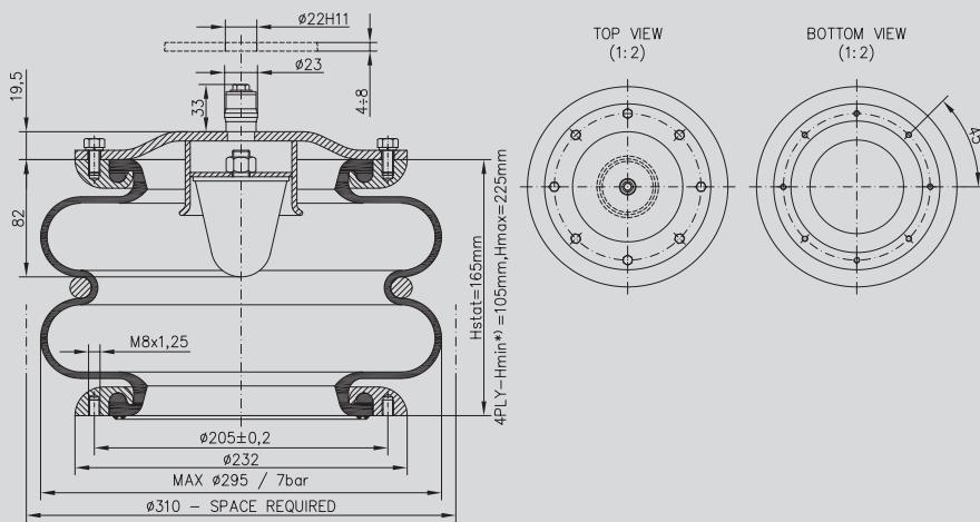
Suspension of axles SOR, Solbus, Kravtex buses. / Odpružení nápravy autobusy SOR, Solbus, Kravtex. / Подпрессоривание мостов автобусов SOR, Solbus, Kravtex.
