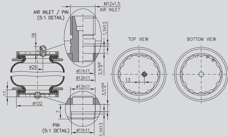
Set is fixed for the pin or combined supply of air. / Komplet fixován za čep resp. kombinovaný přívod vzduchu, zajištěn pojistnými kroužky.
