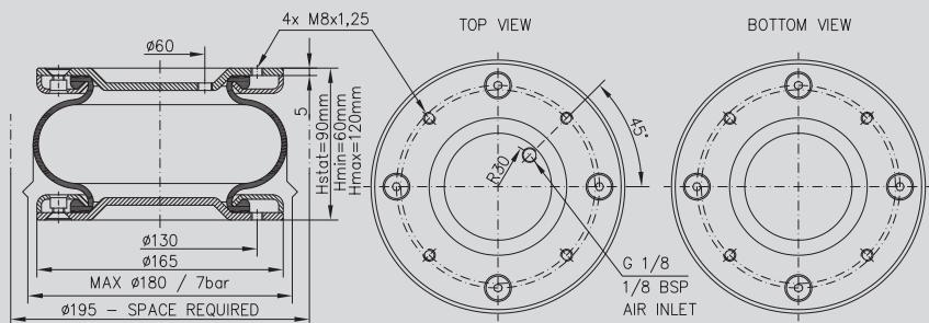
On request, the air inlet thread may be changed to M10x1; possibly, its placement may be changed. / Závit na přívodu vzduchu na požádání můžno změnit na M10x1, příp. změnit jeho umístění. / Резьбу на входе воздуха, по требованию, можно изменить на M10x1 или же изменить место расположения входа.
