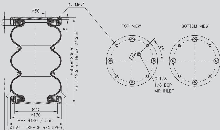
On request, the air inlet thread may be changed to M10x1; possibly, its placement may be changed. / Závit na přívodu vzduchu na požadání může změnit na M10x1, příp. změnit jeho umístění. / Резьбу на входе воздуха, по требованию, можно изменить на M10x1 или же изменить место расположения входа.
