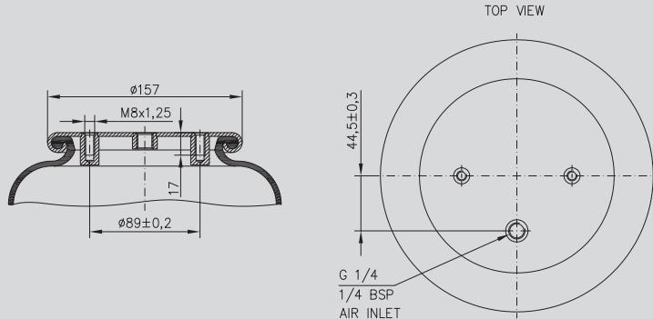
Lifting of truck's axles. / Zvedání náprav u návěsů a souprav. / Подъём мостов грузовиков. Cross ref.: ContiTech FD 200-19, Firestone 20, 20CT, 20F
