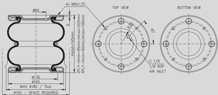
On request, the air inlet thread may be changed to M10x1; possibly, its placement may be changed. / Závit na přívodu vzduchu na požadání možno změnit na M10x1, příp. změnit jeho umístění. / Резьбу на входе воздуха, по требованию, можно изменить на M10x1 или же изменить место расположения входа.
