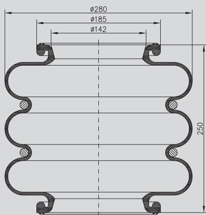
NOTE: Mould cavity dimensions. / POZNÁMKA: Rozměry dutiny formy. / ЗАМЕТКА: Размеры полости формы.
