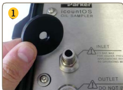
Správně otočte nástroj pro demontáž PRV.
