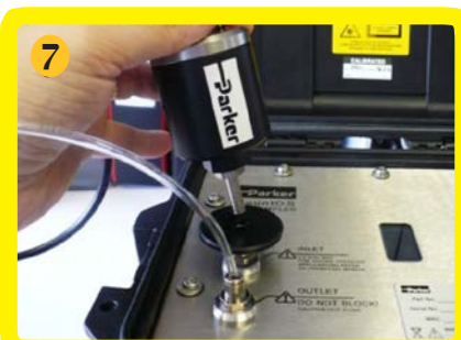
Zatlačte PRV pevně do přípojky INLET .
