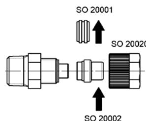
Der Abschlusszapfen lässt sich in jede Verschraubung anstelle eines Klemmringes der gleichen Grösse einsetzen. Wird ein reduzierter Klemmring durch einen Abschlusszapfen ersetzt, so muss immer von der Grösse der Anschlussmutter ausgegangen werden.
